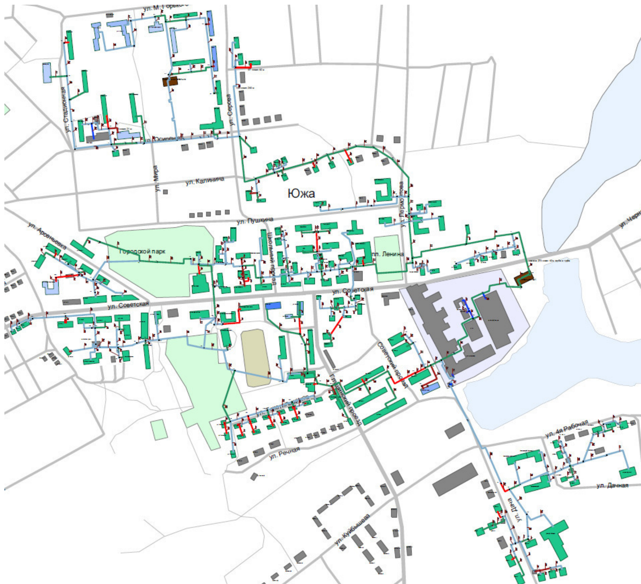
Рис. 5.1.1. Наладка существующего теплогидравлического режима по средствам установки дроссельных сужающих устройств при температурном режиме 80/58.
